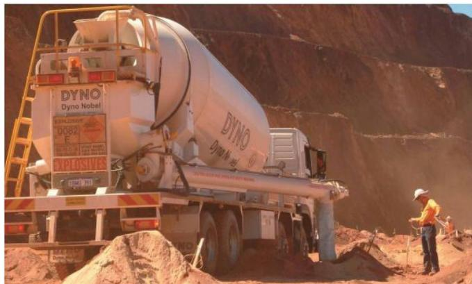
Por otro lado, las condiciones de suelo reactivo requieren explosivos especiales aprobados que inhiben la reacción entre el suelo de sulfuro de hierro y el nitrato de amonio.
